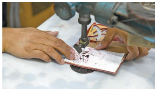
用鑽在膠片字稿上鑽孔，再以線鋸機以人手操作方式鏤出字型。
