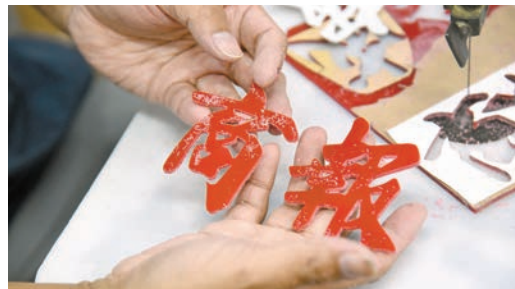
最後將鏤好的字型黏在另一塊磨成圓角的膠片上即告完成。
