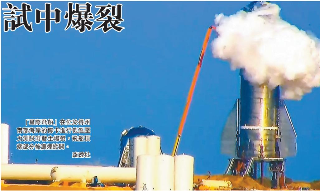
「星際飛船」在位於得州南部海岸的博卡進行低溫壓力測試時發生爆裂，飛船頂端部分被濃煙掀開。
