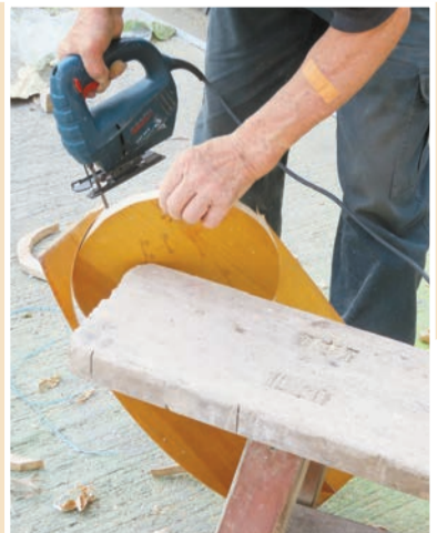
現代器材提升工作效率，只消兩分鐘，電鋸便將做米桶蓋的圓板鋸出來。
