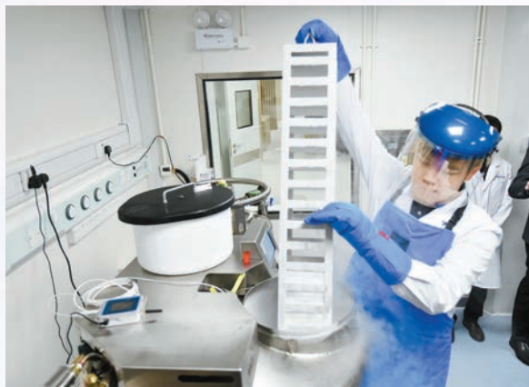
儲存設備包括兩個液氮缸提供液氮（氣態）儲存。
